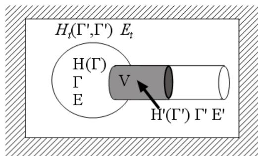
全体のハミルトニアン $H_t(\Gamma, \Gamma')$ は $H_t(\Gamma, \Gamma') = H(\Gamma) + H'(\Gamma') + H_{\text{int}}(\Gamma, \Gamma')$ と書けるが、界面の項 $H_{\text{int}}(\Gamma, \Gamma')$ は無視できるとする。全エネルギーは $E_t = E + E'$ で与えられる。全体は断熱的なのでハミルトニアンの総和はエネルギー $E_t$ でなくてはならないから、全体の確率密度関数 $P_t(\Gamma, \Gamma')$ は
